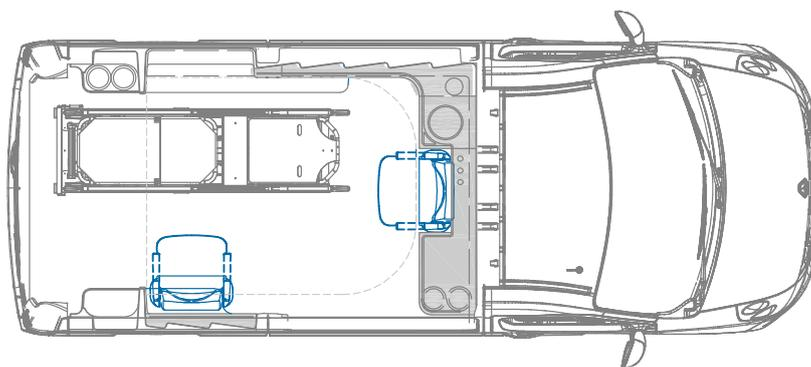
La cabine de conduite compte avec une capacité maximale de 3 places. Le numéro de places avant dépend du poids des accessoires du véhicule originel.
